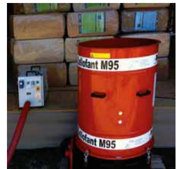
Figure 43 : Machine utilisée pour la mise en œuvre de l'isolant vrac à base de fibres de bois
