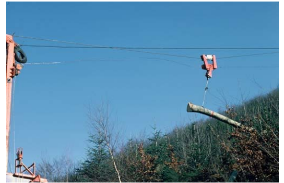
Figure 6 : Débardage par câble (photo : © Pierre Cadiran / ONF)
