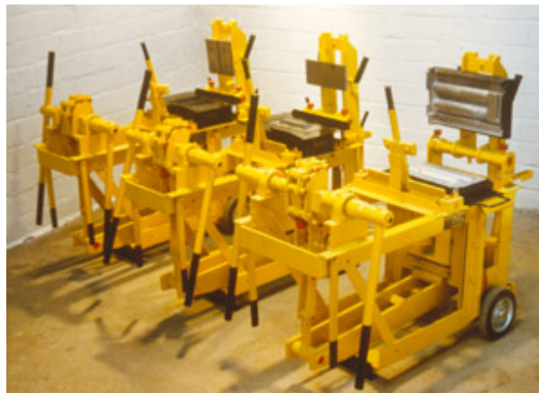
Figure 19 : Presse manuelle utilisée pour la fabrication de brique de terre crue comprimée (source : Appro Techno, machine Terstaram)
