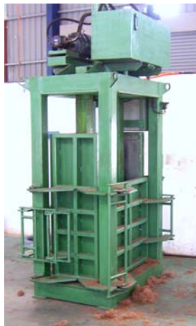
Figure 52: Presse à balles pour fibres de coco et fibres de coco conditionnées en balles (source : CoCoMaN, Coconut Coir Machine Catalogue et swathi exports)
