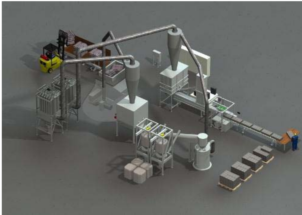
Figure 35 : Illustration d'une unité de production de la ouate de cellulose (Image SOFRED)
