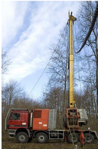
Figure 5 : Débardage par câble (photo © Medad)
