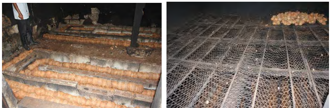
Figure 18 : Système de séchage de M. Armour : A gauche, le four situé au rez-de-chaussée ; A droite, les noix qui séchent au dessus du four
