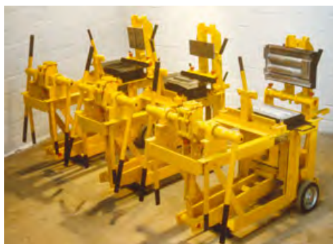
Figure 49 : Presse manuelle utilisée pour la fabrication de brique de terre crue comprimée (source : Appro Techno, machine Terstaram)
