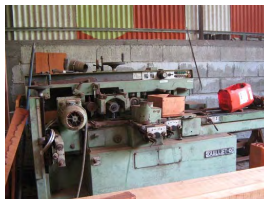
Figure 8 : Photographies des moulurières 4 face et à frise
