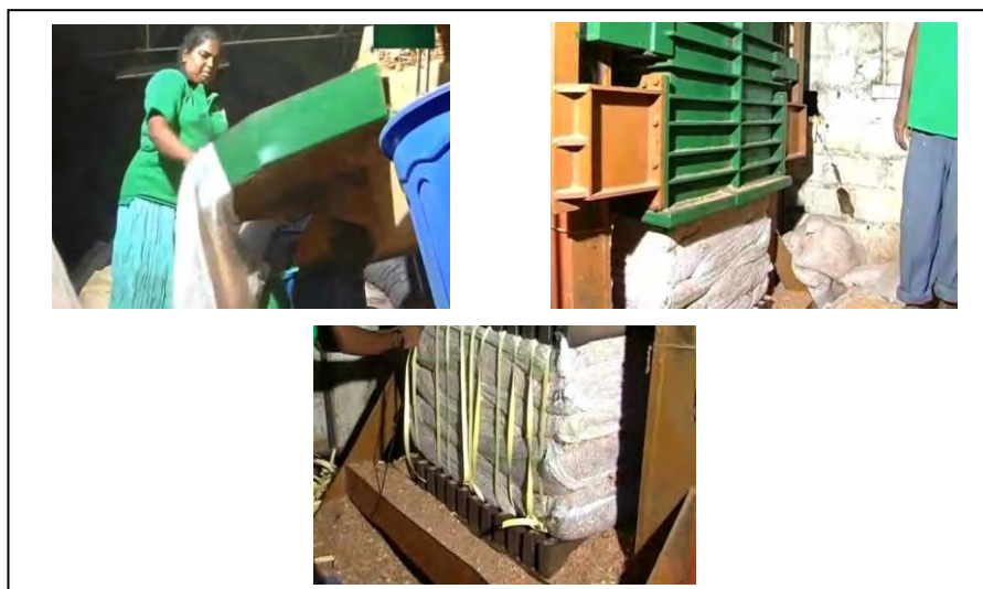
Figure 78: Compactage des copeaux de fibre de coco
