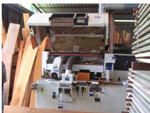
Figure 8 : Photographies des moulurières 4 face et à frise
