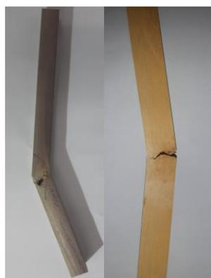
Figure 43 : Eprouvettes supprimées du dépouillement en raison de singularités, ici des nœuds, ayant conduit à une rupture prématurée lors des essais
