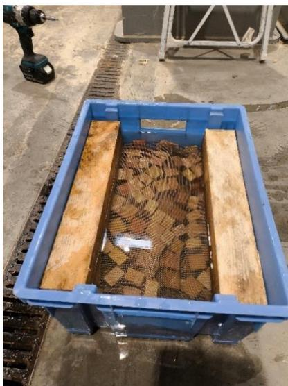
Figure 38 : Immersion des éprouvettes afin d'assurer l'état de saturation des bois
