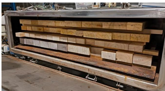
Figure 24 : Disposition des éprouvettes dans le séchoir
