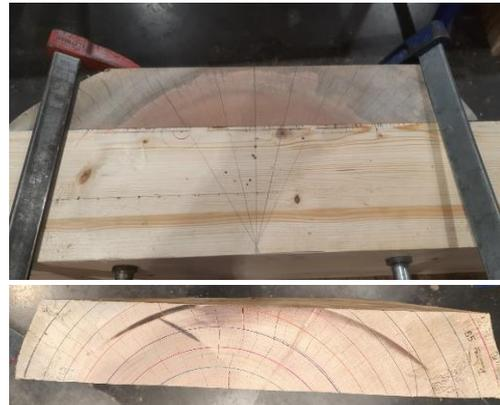
Figure 15 : Tracé d'une section transversale de plateau éloignée de la moëlle
