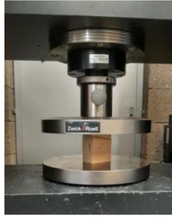
Figure 32 : Banc d'essai de compression transversale et rupture type d'une éprouvette sollicitée de la sorte
