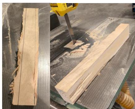
Figure 17 : Délignage à l'aide d'une scie à ruban
