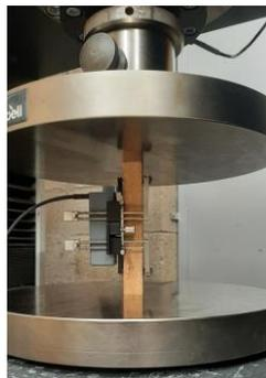
Figure 31 : Banc d'essai de compression axiale avec capteur de prise du module d'élasticité
