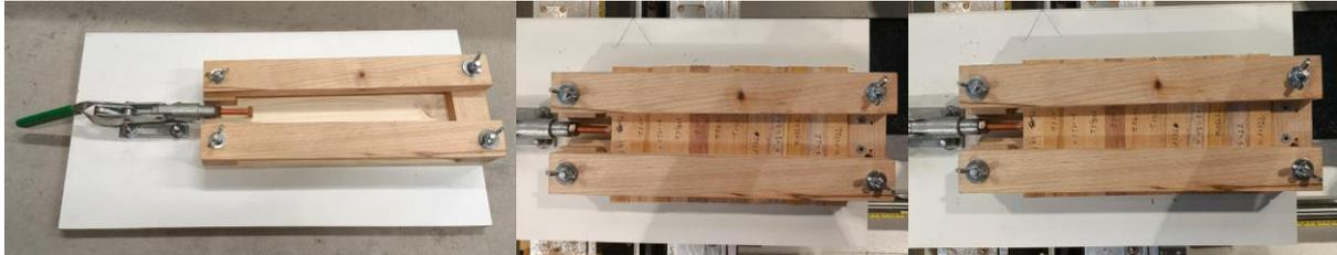
Figure 30 : Gabarit de rectification de faces et échantillons avant et après rectification de la longueur par machine à commande numérique
