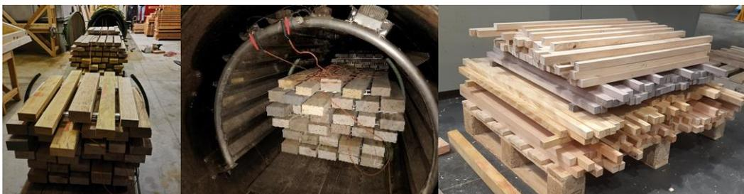
Figure 25 : De gauche à droite, les deux premières photographies montrent le séchoir sous vide du lycée avec les éprouvettes disposées sur le chariot. La troisième photographie montre les éprouvettes de 30x30mm corroyées et prêtes au tronçonnage
