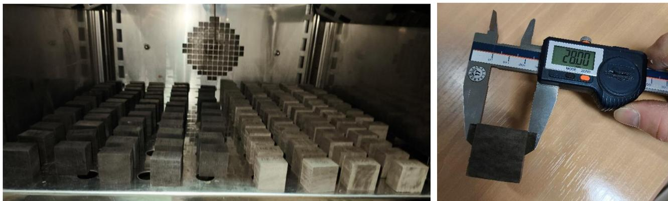
Figure 39 : Séchage des éprouvettes à l'étuve et relevé dimensionnel au pied à coulisse.
