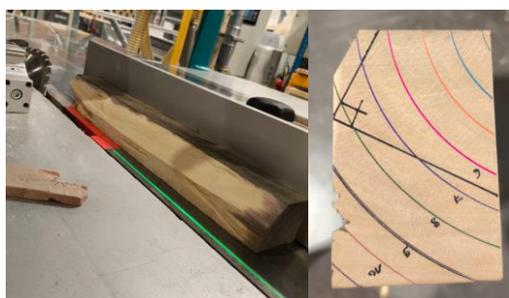
Figure 18 : Délignage avec pente
