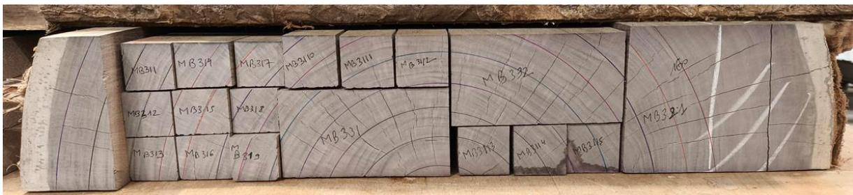
Figure 22 : Illustration du marquage des éprouvettes
