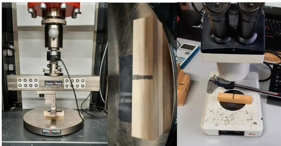
Figure 37 : Banc d'essai de dureté Monnin et mesure de l'empreinte.
