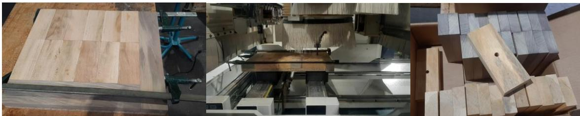
Figure 34 : Perçage des éprouvettes de portance à l'aide d'une machine à commande numérique.
